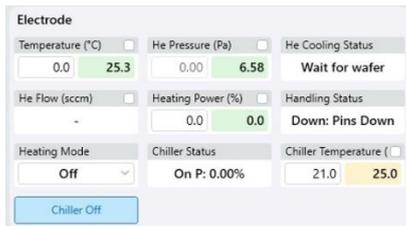
2. 如果反应器中有样品，请执行 unload wafer (handling)，如果反应器室中没有样品，则执行 evacuate (handling)。
